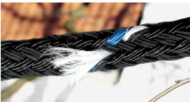
Im Zuge der Qualitätssicherung haben wir 2018 die Gurtbandvarianten 2 t und 4 t (Polyester) einem Bewitterungsversuch unterzogen. Damit sollte sichergestellt werden, dass die Vorgaben und Empfehlungen der ZTV Baumpflege eingehalten werden und die Kunden ein sicheres Qualitätsprodukt bedenkenlos einsetzen können.
