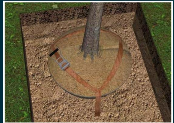
Griff am Hebels ziehen und auseinander gefahrene Ösen über das Ratschenunterteil führen und einrasten lassen. Anschließend feststricken, bis der Gurt stramm angezogen ist. Zuletzt den Hebel lösen - fertig!
