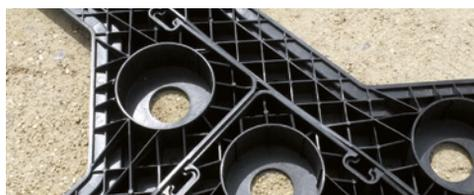
Jedes Deck hat vier Aussparungen, in die im zweiten Schritt die Rundpfosten (Posts) eingesetzt werden. Insgesamt ist das Wurzelkammersystem äußerst flexibel, denn die Länge der Pfosten kann, der Situation entsprechend, auch noch vor Ort modifiziert werden. Diese können auf alle Abmessungen angepasst werden, die zwischen 300 mm und 1500 mm liegen, z.B. bei baubedingten Höhenunterschieden innerhalb der Pflanzgrube. Trotzdem bleiben die Module hoch belastbar.
