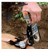
Anschließend wie gewohnt festratschen. Danach am Arretiergriff ziehen – Ösen fahren auseinander – Hebel lösen – fertig!
