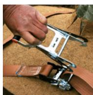
Am Arretiergriff des mitgelieferten Hebels ziehen – Ösen fahren auseinander. Ösen auf das Ratschenunterteil führen und durch Loslassen des Arretiergriffs den Hebel einrasten lassen.
