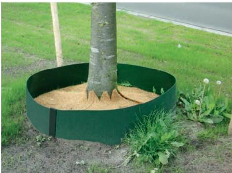
Der Gießrand wird 10 cm ins Erdreich gesteckt und die oberirdisch verbliebenen 20 cm z. B. mit dem Fix Spezialklebeband (S. 26) gegeneinander fixiert. Wir empfehlen die Überlappung mit einer Wachstumszugabe auszustatten. So kann der Gießrand zukünftig dem weiteren Wurzelwachstum angepasst werden. Für eine noch einfachere Fixierung gibt es jetzt den neuen Gießrand Clip. Dieser verbindet ganz einfach die beiden Enden miteinander und erspart das Kleben mit dem GEFA Spezialklebeband.
