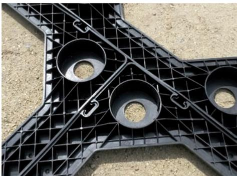
Jedes Deck hat vier Aussparungen, in die im zweiten Schritt die Rundpfosten eingesetzt werden. Insgesamt ist das Wurzelkammersystem äußerst flexibel, denn die Länge der Pfosten kann, der Situation entsprechend, auch noch vor Ort modifiziert werden. Diese können auf alle Abmessungen angepasst werden, die zwischen 300 mm und 1500 mm liegen, z. B. bei baubedingten Höhenunterschieden innerhalb der Pflanzgrube. Trotzdem bleiben die Module hoch belastbar.
