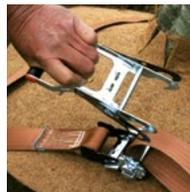
Am Arretiergriff des separat zu bestellenden Hebels ziehen – Ösen fahren auseinander. Ösen auf das Ratschenunterteil führen und durch Loslassen des Arretiergriffs den Hebel einrasten lassen.
