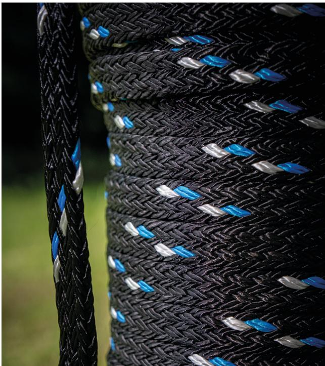
Die Seile wurden beidseitig mit einem Augspleiß versehen und geprüft. Das Ergebnis: Die dynamischen Tawe aus Polyester und Polyamid liegen auch nach simulierten 10 Jahren Bewitterung noch über den erforderlichen Bruchkräften. Damit können diese Kronensicherung mehr als die von der ZTV geforderten 8 Jahre im Baum verbleiben – vorausgesetzt bei den vorgeschriebenen Baumkontrollen ergeben sich nicht Umstände, die zu einem Austausch zwingen.
