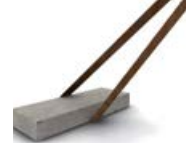
Kontergewicht (z. B. Beton)
