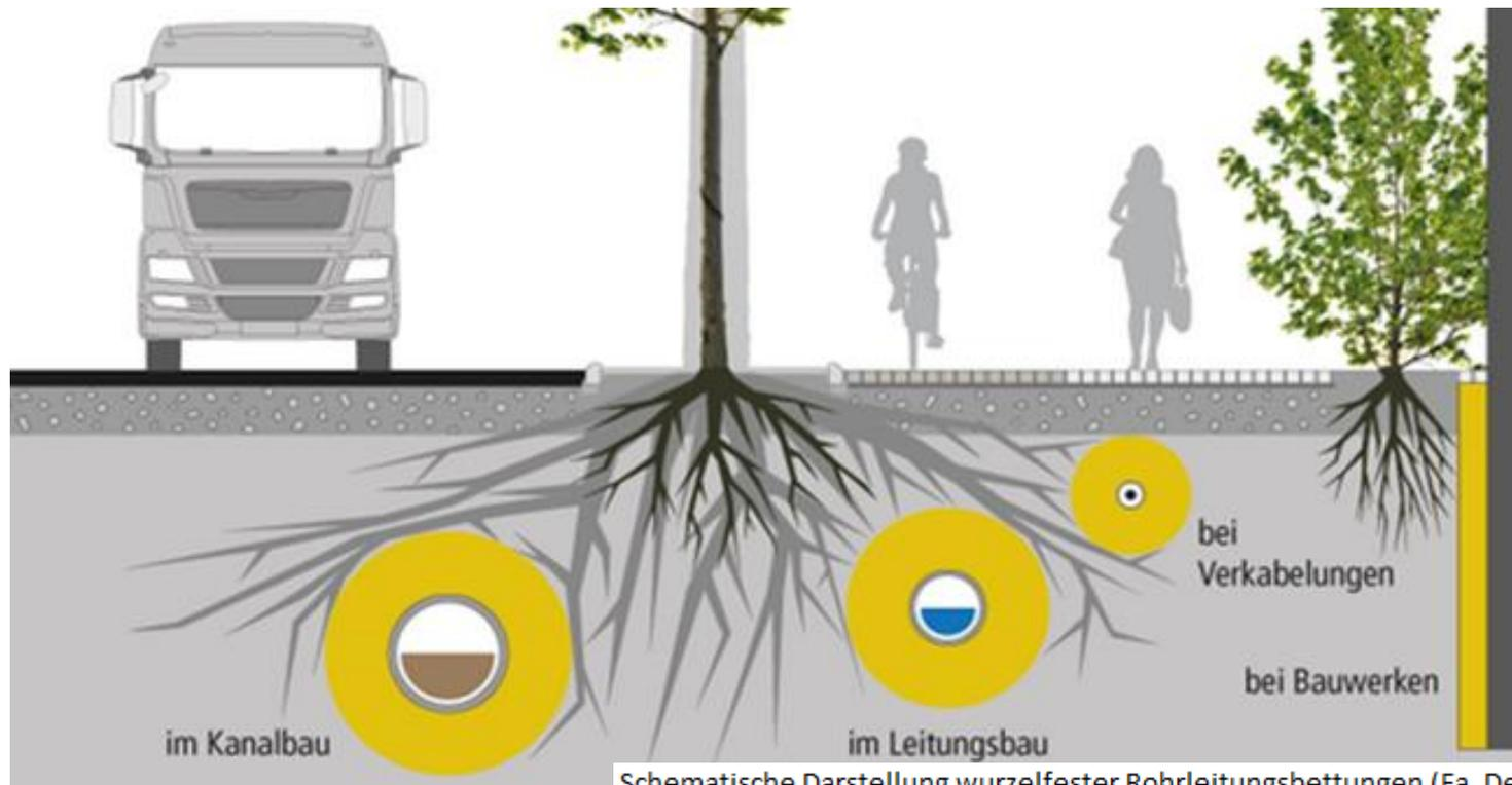
Schematische Darstellung wurzelfester Rohrleitungsbettungen (Fa. Dernoton)
