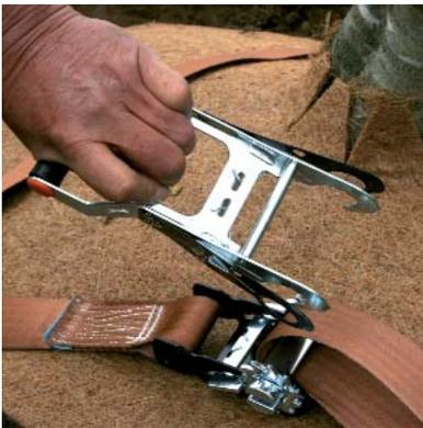
Am Arretiergriff des mitgelieferten Hebels ziehen – Ösen fahren auseinander. Ösen auf das Ratschenunterteil setzen und durch Loslassen des Arretiergriffs den Hebel einrasten lassen.
