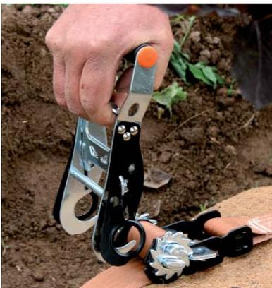
Am Arretiergriff ziehen – Ösen fahren auseinander – Hebel lösen – fertig für den nächsten Einsatz!
